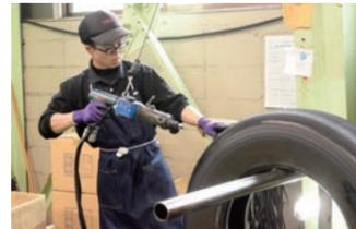
スクイブ工程時にできた補修痕に修理用ゴムを詰めて補修します。
