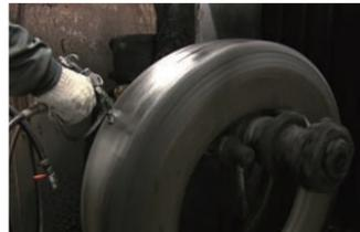
台タイヤの表面に新しいゴムを貼り付けるための接着剤を塗ります。
