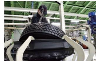
トレッドゴムと台タイヤを確実に密着させるため、耐熱ゴム製の袋に入れて真空パックします。
