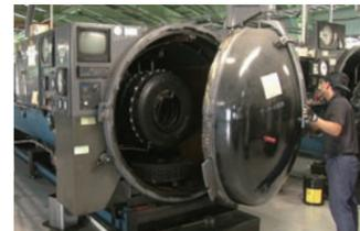
エンベロープされたタイヤを加硫機に入れ、約 99 度の熱を加えてトレッドゴムと台タイヤの間のクッションゴムを加硫します。
