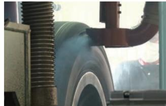
バフマシンにより、路面と接する表面部を削り取り、一定の形状にします。
