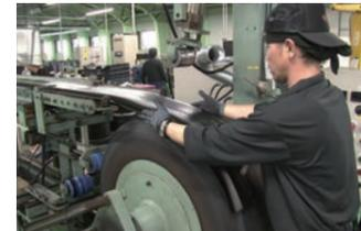
台タイヤの表面に新しいゴムを貼り付け、ローラーで密着させます。
