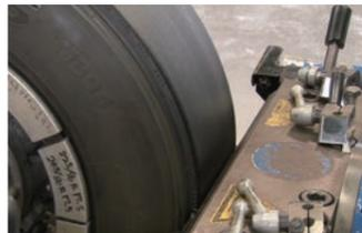
台タイヤの表面に新しいゴムを接着するためのクッションゴムを貼り付けます。
