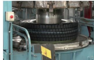
成型したタイヤをモールド（金型）に入れ、熱と圧力を加えてトレッド面に新しいパターンを形成します。
