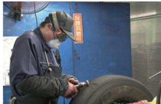
表面を目視で検査。損傷部分があれば補強します。
